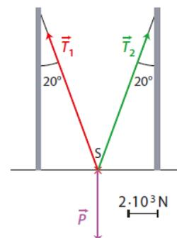
2. a. Construction de la résultante  $\Sigma \vec{F} = \vec{T}_1 + \vec{T}_2 + \vec{P}$
