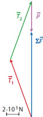
b. Le vecteur  $\Sigma \vec{F}$  a pour direction la verticale et pour sens vers le haut. On détermine sa valeur par mesure sur le schéma ci-dessus :  $\Sigma F = 14 \times 10^3 \text{ N}$ .
