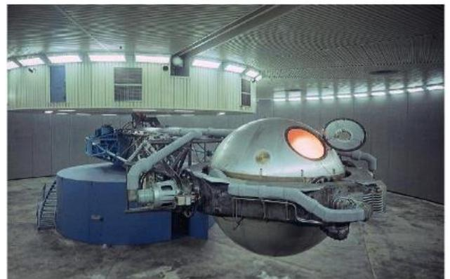
Une centrifugeuse est utilisée pour l'entraînement des astronautes qui peuvent, au cours d'une mission, se retrouver dans des conditions similaires.
