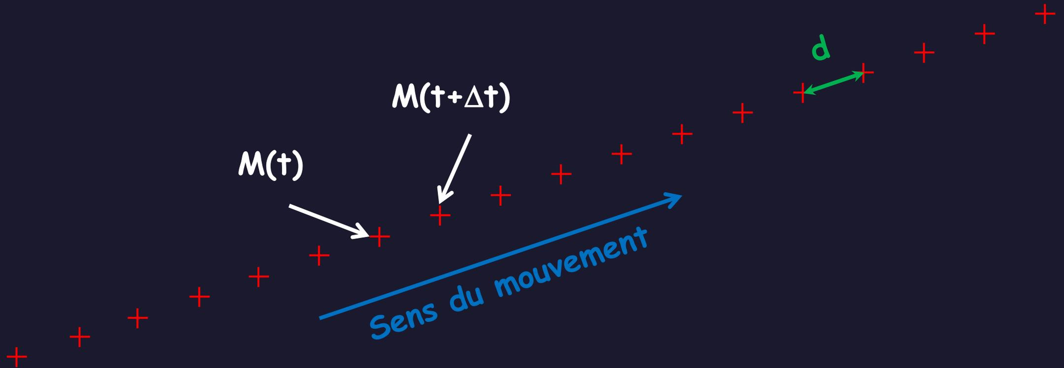
La distance  $d = M(t)M(t+\Delta t)$  parcourue pendant des intervalles de temps  $\Delta t$  identiques reste constante: le mouvement est rectiligne uniforme.
