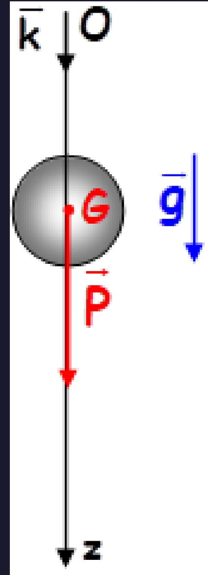
De plus, la bille est petite, de forme sphérique, sa vitesse restera faible (hauteur de chute petite). Dans ces conditions, la force de frottement fluide exercée par l'air sur la surface de la bille est également négligeable par rapport au poids.
